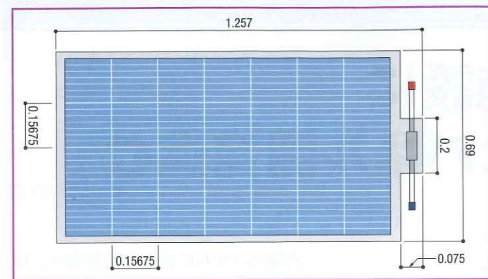
太陽光パネルの外形寸法は1.257m×0.69m×6mm、質量は5.5kg、最大出力は125W。表面には滑り止め加工を施している(出所:コラス、写真:Manuel Lagos Cid-Chump)
