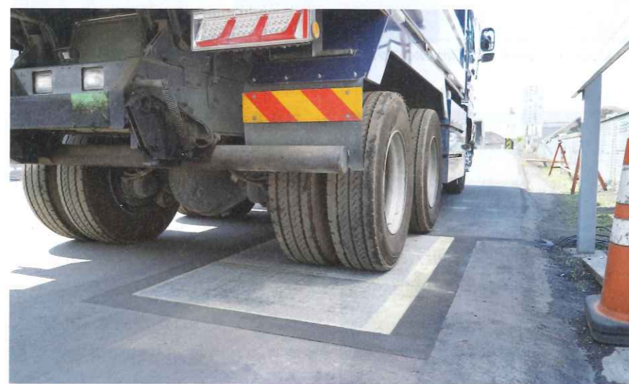
資料1 ■ 大型車の走行による実証実験の様子。太陽光パネルは、仏道路建設会社大手のコラスとフランス国立太陽エネルギー技術研究所(CEA-INES)が開発した製品だ。フランスではパネルの耐久性を確認済み(写真:東亜道路工業)
