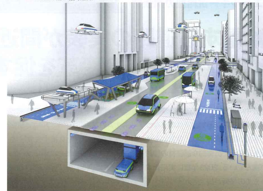
大林組が2022年9月に発表した新しい道路のイメージ「e-MoRoad」(出所:大林組)
