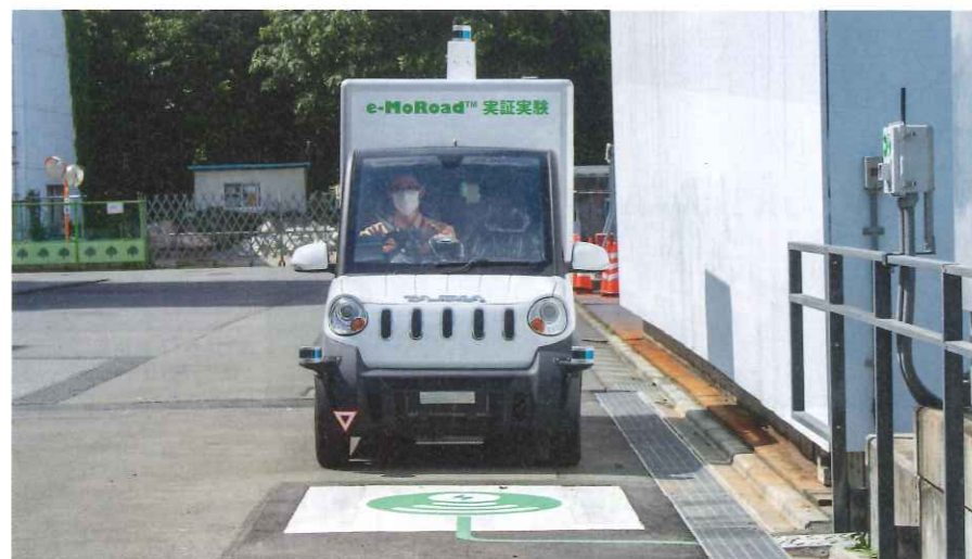
資料5 ■ 大林組の技術研究所構内に敷設した走行中給電システムの上を電気自動車が行く様子(写真:大林組)
